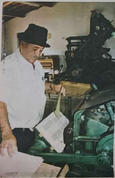
NA ACADEMIA DOS CORDELISTAS do Crato, a chapa para impressão do cordel é feita à mão, letra por letra. Foto: Antônio Veloso
