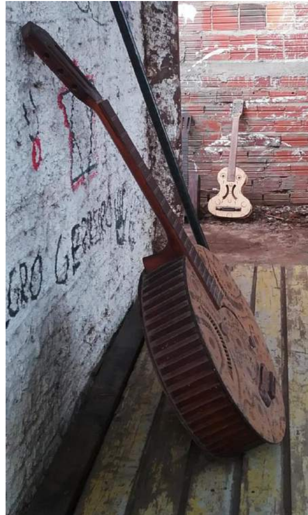
Banjo fabricado com cedro, compensado e louro-canela.
