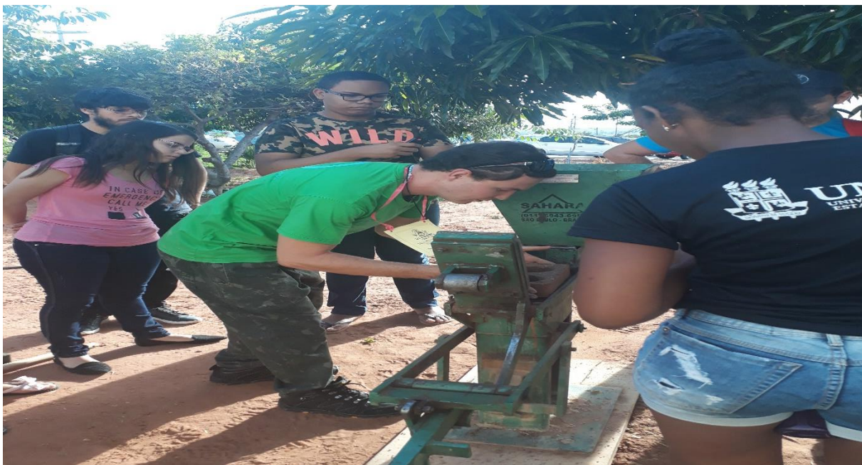
Figura 3: Desforma do Tijolo ecológico na Universidade Federal do Cariri UFCA-Campus Juazeiro do Norte.
